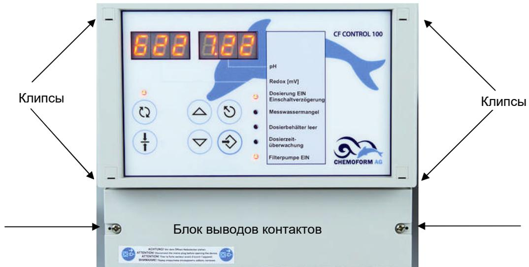
Установка поставляется с измерительными кабелями электродов Redox и pH, подсоединенными к соответствующим контактам. Эти 4 контакта расположены в правой верхней части корпуса. Для доступа к ним необходимо с помощью отвертки с жалом подходящего размера удалить 4 клипсы и вывернуть крепежные винты. После этого осторожно приподнять лицевую панель
